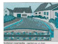
Chaussées à structure réservoir
